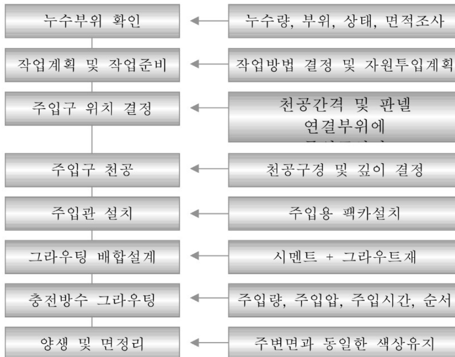
【그림 6.3.10】 충전주입방수 공법의 시공순서도
